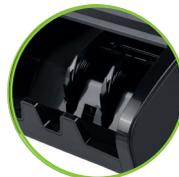
**Bandeja de apiladora:** su bandeja de conteo con capacidad de 300 piezas, con sensor para detección de capacidad max o llenado.
